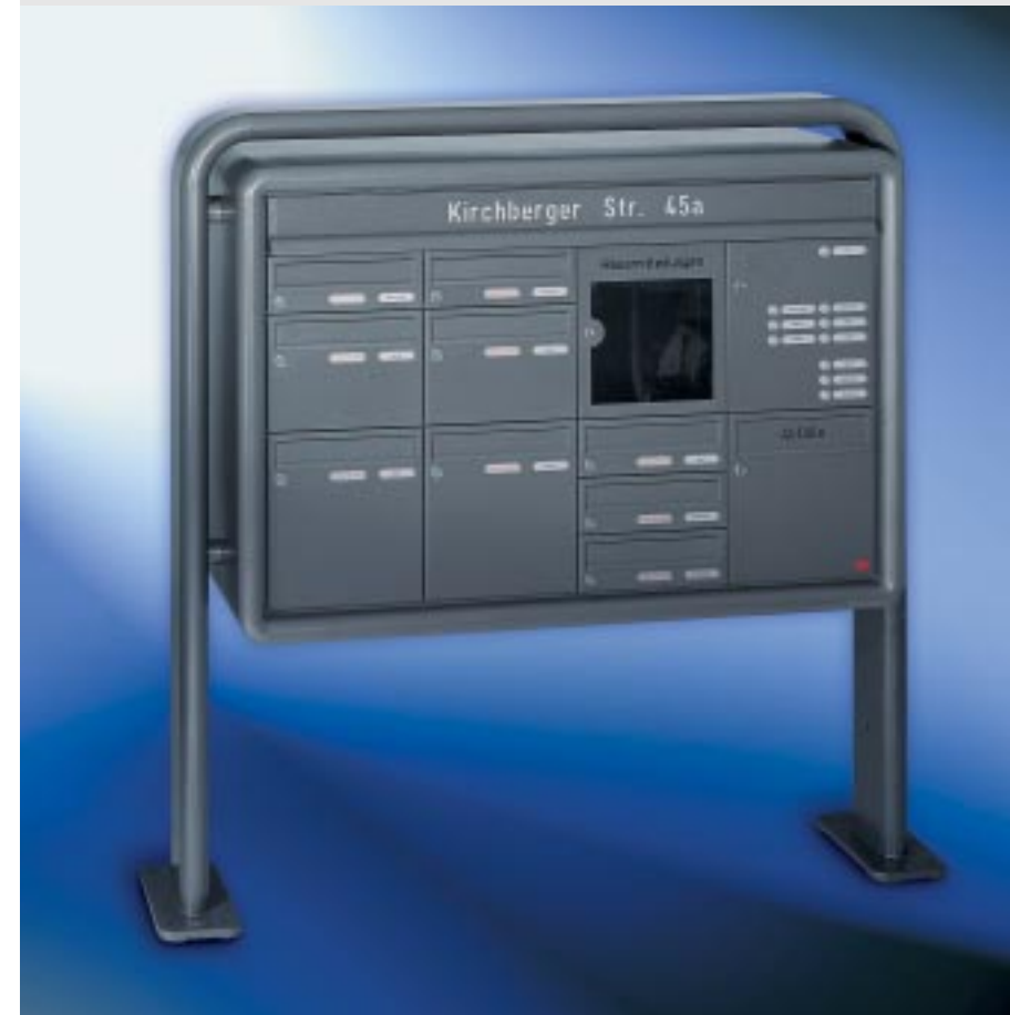
Abb. 93/1 Kastenformat 300 x 110/220/330 x 385 mm, mit RS4 , 2. Namensschild mit Aufschrift „Werbung, nein danke!“, Mitteilungskasten, Abfallbehälter, Beleuchtungskasten, Stahl-Briefkastenverkleidung RS 5000 (schwere, fugenlos geschweißte Stahlblech-Ausführung 2 mm dick), ALU-Ovalrohrgestell 160 x 55 mm.
