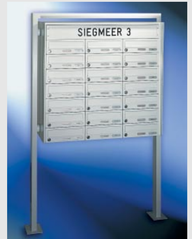
Abb. 91/3 Kastenformat 300 x 110 x 385 mm, mit RS4 , und 2. Namensschild mit Aufschrift "Werbung, nein Danke!". Beschriftungskasten mit Gravur. Enganliegende ALU-Verkleidung vorstehend, eckig, Stahl-Rechteckrohrgestell 80 x 40 mm.
