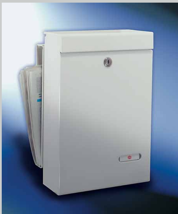
Abb. 3/3 Kasten Modell cubico, Gehäuse, Kipptüre und Einwurflappe aus Stahlblech pulverbeschichtet, Namensschild in RSA - Antivandalismusauführung, Zeitungsbox hinter dem Kasten montiert aus Stahlblech pulverbeschichtet
